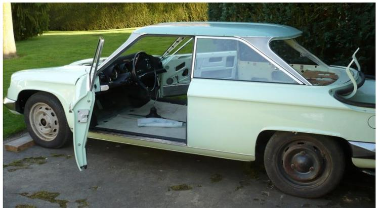
6. Remise en état de la sellerie surtout le dossier arrière, le haut du ski, brûlé par le soleil et l'assise côté chauffeur, défoncée. Pose d'une moquette à l'intérieur et dans le coffre, remplacement du ciel de toit par un neuf.
