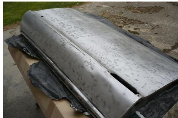
5. Peinture des éléments dans une teinte d'origine puis remontage et (beaucoup, beaucoup d'heures d'ajustage) car tous ces éléments sont fixés par des boulons de 7mm tous remplacés par des boulons inox. Au total, j'ai du racheter deux ailes arrière, une portière, tous les joints de portières et carreaux ainsi que le capot arrière.
