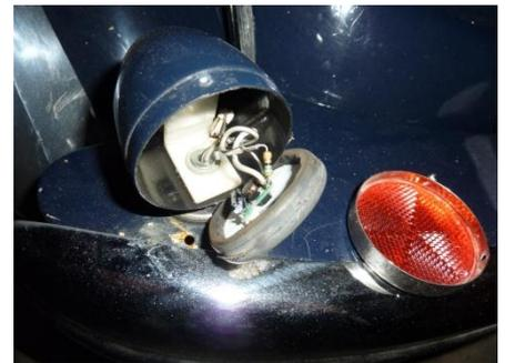
*Le nouveau feu ajouté a été acheté chez un fournisseur bien connu (Renel je crois). J'ai démonté le cabochon et l'ai remplacé par l'intérieur d'un catadioptré, et inséré le circuit de l'ampoule LED. Comme le feu s'illuminait un peu trop fort pour une veilleuse, j'ai raccordé en série une petite résistance (quelques dizaines d'ohms). De ce fait, en court-circuitant la résistance à partir d'une commande au tableau de bord, je pourrais faire une fonction « feux de brouillard arrière »*
